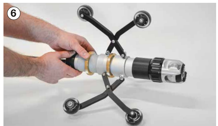
Stellen sie nun das Fahrwerk auf die gewünschte Größe ein und sichern Sie die Einstellung mit der zweiten Rändelscheibe.
