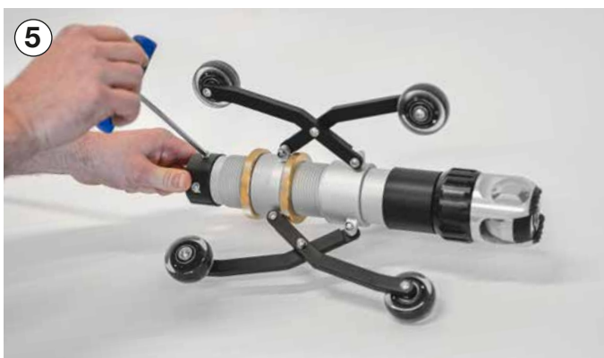
Fixieren sie die Klemmsicherung mit den beiden 5-Inbusschrauben. Damit ist die Kamera im Rollenschlitten gesichert.
