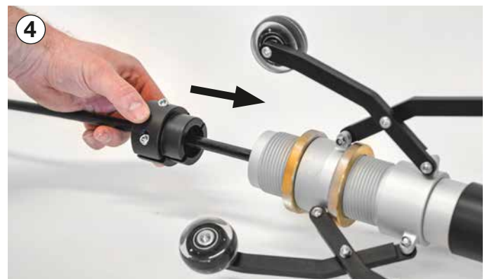
Die Klemmsicherung auf das Schiebekabel aufbringen und in den Rollenschlitten einschieben. Ziehen sie dabei am Schiebekabel, damit die Kamera straff und zentrisch in der Führung sitzt.
