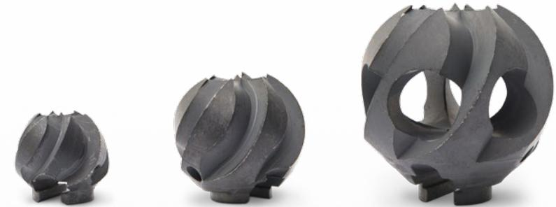
Die **Drillfräser** sind die Weiterentwicklung der bewährten Frästulpen. Die gedrillten Nuten ermöglichen einen verbesserten Material-Abtransport (ähnlich dem Bohrerprinzip). Durch ihre integrierte Kupplung konnte die Baugröße verkleinert werden, was die Drillfräser besonders bogengängig macht. Sie eignen sich zum Aufbohren, Schälen und Fräsen von hartnäckigen Rohrablagerungen (z.B. Urinstein, Kalkstein).
