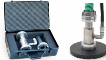
Der **Ringdüsen-Sauginjektor** zum Absaugen von Schächten, Behältern und Anschlüssen verfügt über eine speziell entwickelte Ringdüse. Mit dieser ist er in der Lage, über das Saugrohr (Durchmesser 32 mm) auch Feststoffe (z. B. Steine) von der Größe der Saugöffnung zu fördern.
