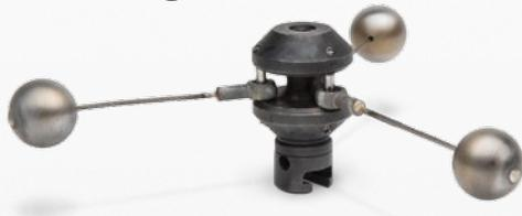
Der **Kugel-Schleuderkopf** dient zur Beseitigung von hartnäckigen Rohrablagerungen (z.B. Betonschlamm). Die in Rotation versetzten Stahlkugeln zerschlagen dabei alle Ablagerungen.
