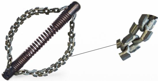
Die **Sägezahn-Kettenschleuder** wird speziell zur Beseitigung von Wurzeln und harten Inkrustierungen eingesetzt. Die aufgelöteten Hartmetallsägezähne besitzen eine deutlich geringere Abnutzung der Ketten im Vergleich zu Standard-Nockenketten.
