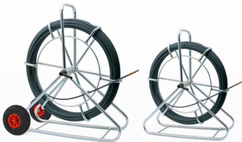
Die **Sende-Röhrenaale** mit Kupfer-Litze dienen zur Trassenortung und Verlaufsbestimmung von nichtmetallischen Rohren. Mit einem Leitungstransmitter oder einem vLoc 10 TX wird die Haspel besendet, so dass der gesamte Verlauf des Schubkabels geortet werden kann. Darüber hinaus werden sie zum Einschieben von Ortungssendern, Muffenprüfgeräten, Rohrverschlüssen und Sanierungspackern eingesetzt.
