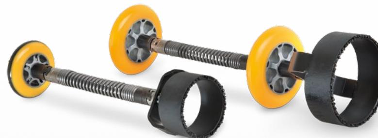
Die **Zentriereinheit** für stimseitig arbeitende Werkzeuge dienen zur Führung von Scheiben- und Ringfräsern in der Rohrmitte. Somit wird ein exaktes Arbeiten mit den Fräsworkzeugen möglich. Die kugelgelagerte Führung dreht sich beim Arbeiten nicht mit, so werden Beschädigungen im Rohr vermieden und ein Schlagen des Werkzeugs verhindert.
