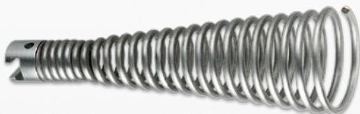
Der **Trichterbohrer** wird speziell bei Textil- und Zelluloseverstopfungen eingesetzt. Durch die trichterartige Formgebung hat dieses Werkzeug einen großen Erfassungsbereich und kann auch bei größeren Rohrdurchmessern eingesetzt werden. Der Trichterbohrer kann auch als Rückholwerkzeug im Rohr verbliebener Spiralen benutzt werden.
