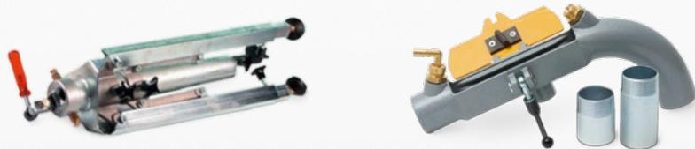
Ideales Hilfsmittel für die Arbeiten an Fallsträngen. Durch ein patentiertes Spiralarückhol-System (Klemmbacken) werden die Spiralen automatisch durch die Rechts-Schaltung der Rohrreinigungs-Maschine aus dem Rohr gefahren. Ein sehr leichtes Arbeiten ist gewährleistet. Passend für 22 mm-Spiralen und 32 mm-Spiralen, für 16 mm sind Sonderausführungen erhältlich.
