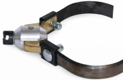
Der **Expansionsschneider** ist ein modernes Spezialwerkzeug zum intensiven Abschaben / Schneiden / Schälen. Durch einen Federmechanismus passen sich die Schneiden des Werkzeugs exakt dem zu bearbeitenden Rohrendurchmesser an. Somit ist das vollständige Entfernen von harten Ablagerungen, Inkrustierungen und faserigem Wurzelwerk kein Problem.
