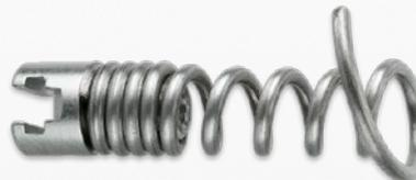
Der **Rückholbohrer** wird dann eingesetzt, wenn im Rohr verbliebene Spiralen zurückgeholt werden müssen. Dieses Werkzeug hat einen ausgestellten Fangarm, um die Spirale zu fassen.
