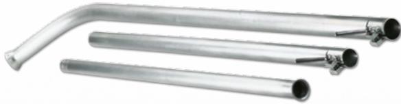
Das **Führungsrohr** fungiert bei Reinigungen an Einstiegsschächten zur Führung der Spiralen. Denn eine ungeführte Spirale kommt ins Schleudern und verschlingert. Bei überfluteten Schächten ist es praktisch unmöglich, die Spirale in das zu reinigende Kanalrohr einzufahren.
