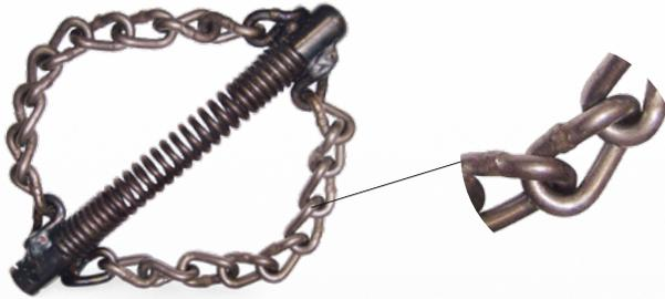
Die **Kettenschleuder mit Glattkette** ist mit das wichtigste Rohrreinigungswerkzeug und wird speziell für die abschließende Reinigung der Rohre benötigt, sie ist besonders oberflächenschonend bei Guss- (NK) und Kunststoffrohren (GK).
