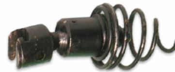
Der **Gelenk-Keulenbohrer kurz** kombiniert die Vorteile des Gelenks, wie bei dem Gelenk-Keulenbohrer, mit einer besonders kurzen Bauform und ist somit für Einsätze in engen bis sehr engen Rohrbögen geeignet. Darüber hinaus ist das Werkzeug auch als Rückholbohrer verwendbar.
