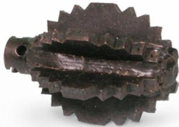
Der **Igelfräser** ist speziell für Falleitungen entwickelt worden. Hier entfernt er mühelos schwere Inkrustierungen mit seinen 6 lasergeschnittenen starken Fräsblättern, welche in beide Richtungen Zahnungen aufweisen. Das hohe Eigengewicht ist besonders gegen schwere Inkrustierungen in Falleitungen geeignet.
