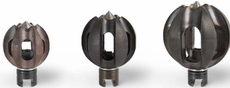
Die **Frästulpe** ist ein äußerst wirksamer und bogengängiger Rohr-Drillfräser zum Aufbohren, Schälen und Fräsen von Rohrablagerungen im Haustechnikbereich und geeignet für den Einsatz bei Fallleitungen. Durch ihre Konstruktion werden Schäden am Rohr verhindert.
