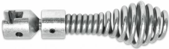
Der **Gelenk-Keulenbohrer** in Kombination mit dem Gelenk erleichtert das Vordringen in engen Rohrbögen gegenüber dem Standard-Keulenbohrer. Wie auch bei dem normalen Keulenbohrer, ist dieser nur für leichte Textil- und Zelluloseverstopfungen geeignet.
