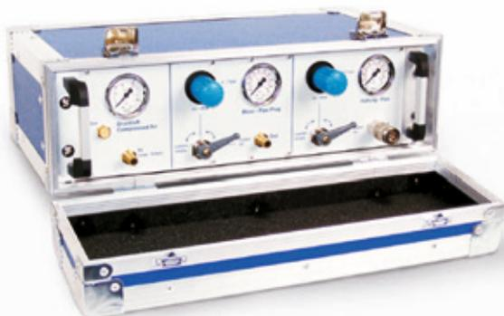
Der **Multi-Druckluftkoffer** dient zur Befüllung, Steuerung und Überwachung von Prüf-dichtkissen sowie des zu prüfenden Objektes (z.B. Haltungsdruck) bei Dichtigkeitsprüfungen mit Überdruckmessung. Das Gerät verfügt über einen Kompressoranschluss (bis max. 8 bar), einen Anschluss für Prüf- bzw. Absperrblasen und einen Anschluss zur Befüllung und Überwachung des Prüfobjektes.
