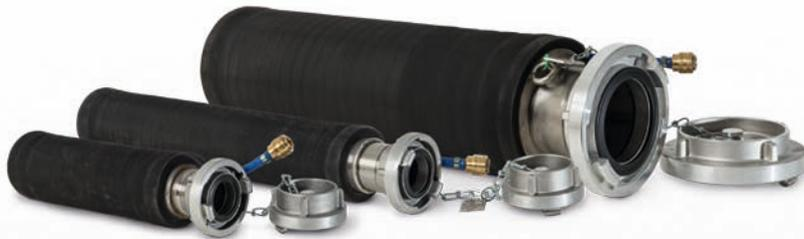
Die **Bypass-Rohrverschlüsse** mit großem Zentraldurchgang aus Edelstahl werden überall dort eingesetzt, wo es größere Durchflussmengen gibt. Der Edelstahlkern ist mit dem Mantel aus robustem Gummigewebe überzogen und kann problemlos getauscht werden.
