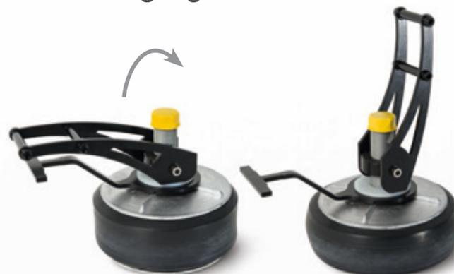
Die **FIX-Dicht-Schnellspanverschlüsse aus Aluminium** sind die robuste und langlebige Version der neuen Verschlusssteller für die schnelle, zuverlässige und sichere Abdichtung von Rohrenden. Mit der Anbringung eines Zugseils ist es möglich, den Rohrverschluss sicher aus dem Schacht zu entfernen, ohne ihn betreten zu müssen. Dies ermöglicht den Einmann-Betrieb und gewährleistet die Einhaltung der Sicherheitsregeln der Berufsgenossenschaft (BGR 126).
