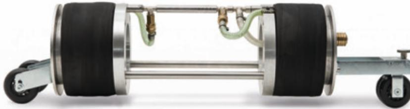
Das **Indukom-Muffengerät Grundsystem** dient der punktgenauen Prüfung im Muffenbereich von nicht begehbaren Rohrleitungen mit Luftüberdruck bzw. Vakuum nach DIN-EN1610. Das modulare Grundgerät für DN 200 lässt sich mit wechselbaren Prüf-Scheibensätzen für Kanäle bis DN 600 verwenden.
