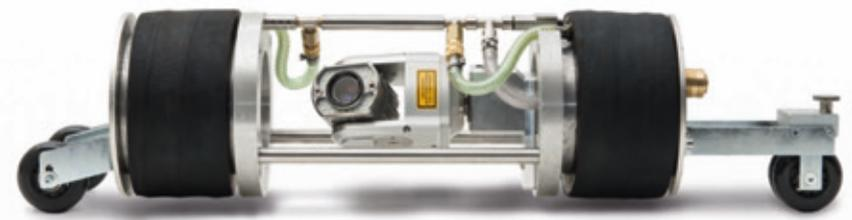
Das **TV-Indukom-Muffengerät Grundsystem** dient der punktgenauen Prüfung im Muffenbereich von nicht begehbaren Rohrleitungen mit Luftüberdruck bzw. Vakuum nach DIN-EN1610. Das modulare TV-Grundgerät verfügt über eine Kameraaufnahme für Inspektionssysteme und lässt sich auch ab DN 200 einsetzen. Mit den wechselbaren Prüf-Scheibensätzen ist es für Kanäle bis DN 600 verwendbar.
