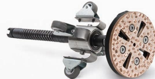
Die **Zentrierschlitten** für stirnseitig arbeitende Werkzeuge dienen zur Führung von Scheiben- und Ringfräsern in der Rohrmitte. Somit wird ein exaktes Arbeiten mit den Fräs Werkzeugen möglich. Durch zwei Kugellager dreht sich der Führungsschlitten beim Arbeiten nicht mit, sondern steht fest im Rohr.
