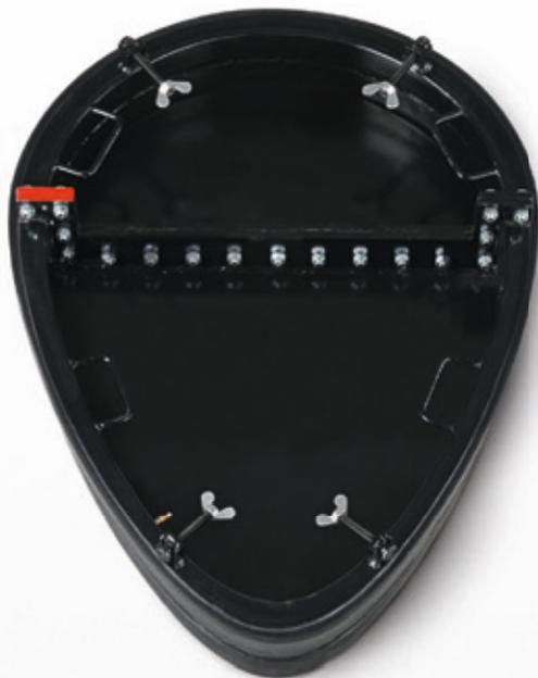
Die **pneumatischen Ei-Profil Absperrscheiben** in einfacher oder mehrteiliger Ausführung sind sehr robust und verfügen über 2 austauschbare Hohlkammer-Dichtringe. Sie dienen dem sicheren und zuverlässigen Absperrn von Entwässerungskanälen. Der mehrteilig geschraubte Aufbau ermöglicht dabei das Einbringen z.B. durch eine Schachttöffnung.
