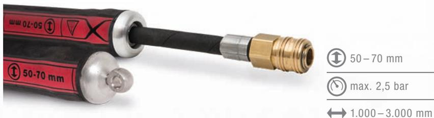
Unsere **Hausanschluss-Packer DN 50 - 70 mm** mit der Flex-Luftkupplung ermöglichen eine besonders gute Bogengängigkeit auch bei 90° Bögen. Der Flex-Einsatz zwischen Packerkupplung und Luftanschluss ist dabei aber steif genug um einen optimalen Vorschub zu gewährleisten.
