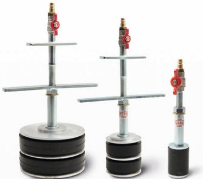
Die **Presskolben (Niederdruck)** sind mechanische Rohrverschlüsse und werden zum Absperrn oder Prüfen von Rohr- bzw. Wasserleitungen verwendet. Einsatzgebiete sind Industrieanlagen, Schiffs- und Anlagenbau. Unsere Presskolben sind auch als Prüfelement mit Manometer oder als Entlüftungselement erhältlich.
