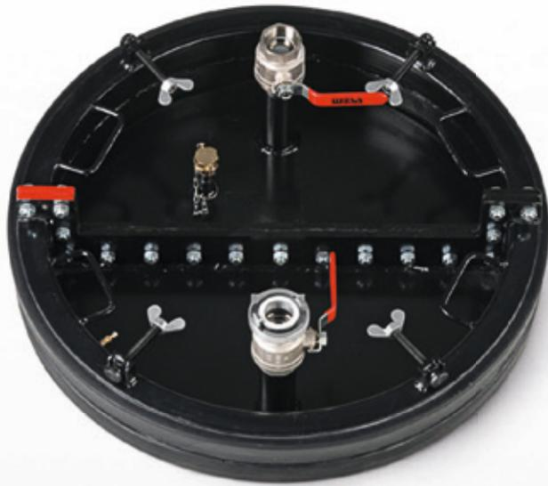
Die **pneumatischen Prüf-Absperrscheiben** mit Durchgang in einfacher oder mehrteiliger Ausführung sind sehr robust und verfügen über 2 auswechselbare Hohlkammer-Dichtringe. Der Durchgang ermöglicht das Prüfen von Rohr- und Abwasserleitungen nach DIN EN 1610 mit Luft oder Wasser.
