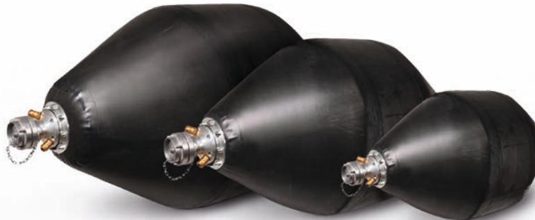
Die **Prüf-Allround-Faltdichtkissen** ermöglichen den universellen Einsatz in allen Norm- und Ei- und sogar Kastenprofilen. Sie erfüllen gleich drei Funktionen in einer: Dichten, Prüfen mit Wasser oder Luft und Umleiten / Ableiten. Das hochwertige Kevlar-Gewebe mit der Neopren-Beschichtung macht die Faltkissen besonders chemikalienresistent bei geringem Gewicht.
