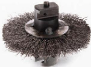
Die **Scheibenbürsten** dienen zum Reinigen und Aufrauen von PVC- und Gussrohren für die Vorbereitung zur Sanierung. Die Nut / Stift Ausführung ermöglicht das Koppeln mehrerer Scheibenbürsten hintereinander. Diese ermöglichen eine optimierte Reinigungsleistung.
