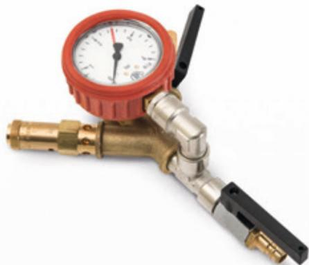
Die **Sicherheitssteuerorgane** verfügen über ein Überströmventil, dieses gewährleistet die Begrenzung des Prüfdruckes. Das Sicherheitsventil und Manometer kann je nach Druckbereich ausgewählt werden (von 0,5 bar - 5 bar).
