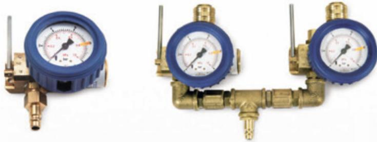
Die **Sicherheitssteuerorgane** verfügen über ein Überströmventil, dieses gewährleistet die Begrenzung des Betriebsdrucks auf 8 bar. So wird ein Überfüllen der Hebekissen verhindert. Mit Kugelhahn, Sicherheitsventil, Standard-Luftkupplungen und Ausgangsmanometer.
