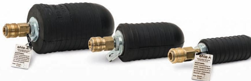
Die **Rohrdichtkissen halbrund** verfügen über eine besonders geringe Länge (bzw. Einbautiefe), dadurch eignen sie sich hervorragend zum einfachen und schnellen Verschließen von Anschlussleitungen und Hausanschlüssen mit Bögen. Die halbrunde Form ermöglicht es das Rohrdichtkissen weit im Bogen zu installieren, so können diese auch in Rohrleitungen mit schwierigen Einbausituation verwendet werden.
