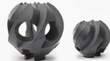
Die **Drillfräser** eignen sich zum Aufbohren, Schälen und Fräsen von hartnäckigen Rohrablagerungen, sowie zum Öffnen von überklebten Einläufen bei einer Rohrsanierung. Die gedrillten Nuten ermöglichen einen verbesserten Material-Abtransport (ähnlich dem Bohrerprinzip). Durch ihre integrierte Kupplung konnte die Baugröße verkleinert werden, was sie besonders bogengängig macht, so stellen auch 87° Bögen kein Problem dar.
