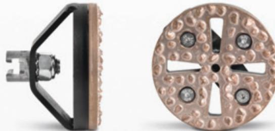
Unsere **Scheiben-Fräser** wurden speziell für Urinstein, härteste Inkrustierungen, Betonschlämme oder ähnliches entwickelt. In einem speziellen Verfahren werden Hartmetallteilchen auf eine Fräsplatte aufgebracht und gehärtet - das macht das Werkzeug besonders robust. Trotz hoher Standfestigkeit kommt es an jedem Fräs Werkzeug zu Verschleiß. Mit unseren wechselbaren Fräsplatten ist ein kostengünstiger Austausch möglich.
