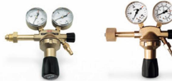
Die **Flaschen-Druckminderer bzw. Reduzierventile** sind für nichtbrennbare Gase geeignet und reduzieren den Flaschendruck von 200 bar / 300 bar auf 8 bar. Sie dienen dem Befüllen von Hebekissen.
