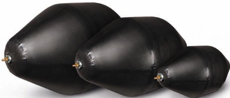
Die **Allround-Faltdichtkissen** mit dem Doppelkonussystem ermöglichen den universellen Einsatz in allen Norm-, Ei- und sogar Kastenprofilen. Sie bestehen aus hochwertigem Kevlar-Gewebe mit einer Neopren-Beschichtung. Diese macht die Faltkissen besonders chemikalienresistent bei geringem Gewicht.
