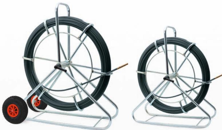
Die **Sende-Röhrenaale** mit Kupfer-Litze dienen zur Trassenortung und Verlaufsbestimmung von nichtmetallischen Rohren. Mit einem Leitungstransmitter oder einem vLoc 10 TX wird die Haspel besendet, so dass der gesamte Verlauf des Schubkabels geortet werden kann. Darüber hinaus werden sie zum Einschleiben von Ortungssendern, Muffenprüfgeräten, Rohrverschlüssen und Sanierungspackern eingesetzt.
