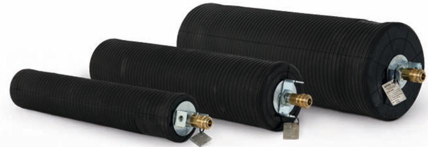
Die **Hochdruck-Rohrdichtkissen** kommen immer dann zum Einsatz, wo keine Standard-Dichtkissen wegen eines hohen Gegendrucks in der Rohrleitung eingesetzt werden können. Der höhere Betriebsdruck von (6,0 bar) ermöglicht eine besondere Kevlar-Gewebeeinlage, sie hält einem Gegendruck bis zu 30 m Wassersäule (3,0 bar) stand.
