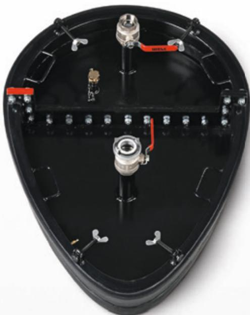
Die **pneumatischen Ei-Profil Prüf-Absperrscheiben** mit Durchgang in einfacher oder mehrteiliger Ausführung sind sehr robust und verfügen über 2 auswechselbare Hohlkammer-Dichtringe. Der Durchgang ermöglicht das Prüfen von Rohr- und Abwasserleitungen nach DIN EN 1610 mit Luft oder Wasser.
