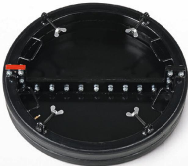
Die **pneumatischen Absperrscheiben** in einfacher oder mehrteiliger Ausführung sind sehr robust und verfügen über 2 austauschbare Hohlkammer-Dichtringe. Sie dienen dem sicheren und zuverlässigen Absperrern von Entwässerungskanälen. Der mehrteilig geschraubte Aufbau ermöglicht dabei das Einbringen z.B. durch eine Schachttöffnung.
