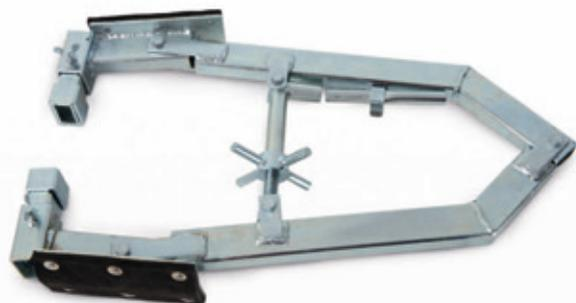
Die **Verbaugeräte** sind eine einfache und sichere Lösung, Rohrverschlüsse und Rohrprüfgeräte praxisingerecht gegen Herausschieben zu sichern. Im Vergleich zu einem herkömmlichen, aufwendigen und zeitintensiven Holzverbau können sie schnell und beliebig oft eingesetzt werden. Selbst bei glatten oder schlüpfrigen Rohrwänden wird ein zuverlässiger Verbau durch die Spezial-Gummibeläge erreicht.
