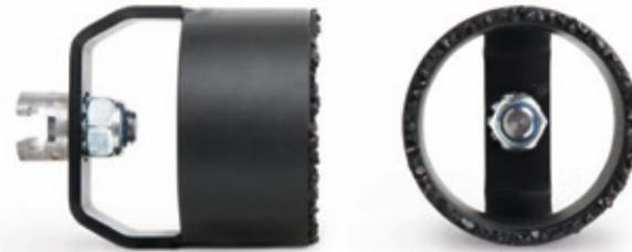
Die **Hartmetall-Ringfräser** sind speziell für Rohrstanier entwickelt worden. Diese Werkzeuge werden z. B. zum Auffräsen von Anschlüssen nach der Sanierung eingesetzt. In einem speziellen Verfahren werden Hartmetallteilchen auf die Oberfläche des Bohrers aufgetragen und anschließend gehärtet. Dadurch ist das Werkzeug bruch- und schlagfest und kann eine hohe Standfestigkeit gewährleisten.
