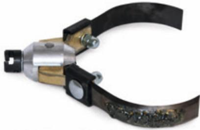
Der **Expansionsfräser** basiert auf dem gleichen Prinzip wie der Expander-Schneider. Der Unterschied besteht in den Hartmetall besetzten Schneiden. Diese machen das Werkzeug ideal zur Vorbereitung (Aufrauen) von Sanierarbeiten sowie zum Fräsen von hartnäckigen Inkrustierungen. Auch besonders geeignet für Inliner-Arbeiten.
