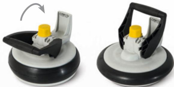
Die **FIX-Dicht-Schnellspanverschlüsse aus Kunststoff** bieten eine schnelle, zuverlässige und sichere Abdichtung von Rohrenden. Mit dem Teleskop-Schnellspanner lassen sich die Verschlusssteller einfach und sicher ein- bzw. ausbauen, dies macht den Einstieg z.B. in den Schacht überflüssig. Durch diese Fernbedienung oder die Anbringung eines Zugseils wird der Einmann-Betrieb möglich und die Einhaltung der Sicherheitsregeln der Berufsgenossenschaft (BGR 126) gewährleistet.
