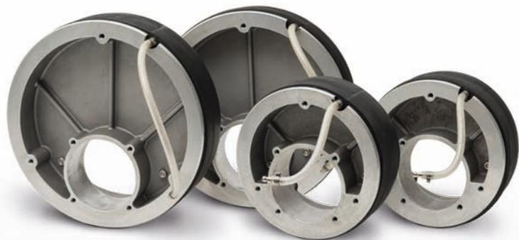
Die **Indukom-Prüfscheibensätze** ermöglichen den Einsatz der Indukom-Grundsysteme bis DN 600 für nicht begehbare Rohr- und Kanalsysteme. In der Entwicklung standen die Skalierbarkeit und eine kurze Rüstzeit im Vordergrund. Die Prüfscheiben sind komplett vormontiert und werden einfach auf das Grundsystem aufgeschoben und mit 4 Schrauben fixiert. Die Luftversorgung wird mittels Luft-Schnellkupplungen hergestellt.
