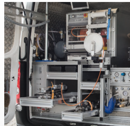
» 带有组合设备的后备箱 - 电视检查技术 «
