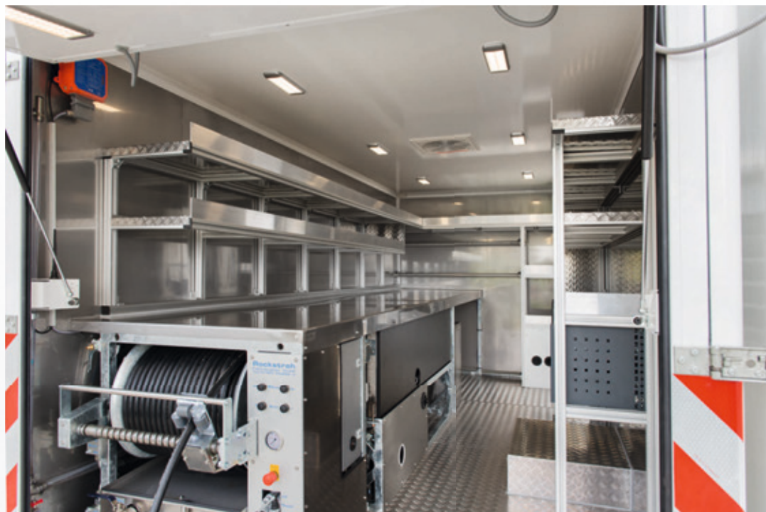
使用辅助驱动的液压高压设备
