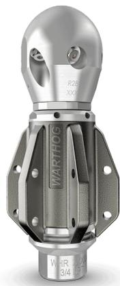
Die WHR und WGR Magnum Umschaltdüsen kombinieren die maximale Vortriebs- mit der maximalen Reinigungsleistung. Mit den Düsen ist es möglich den vollen Durchfluss für den Vortrieb- und die Abschwemmlistung zu nutzen. Dann Umzuschalten und beim Zurückziehen die maximale Wasserleistung auf den Reinigungsstrahlkreis zu verwenden. Damit lassen sich die hartnäckigsten Ablagerungen in Leitungen von 150 - 450 mm (WHR Magnum) und 200 - 900 mm (WGR Magnum) lösen.
