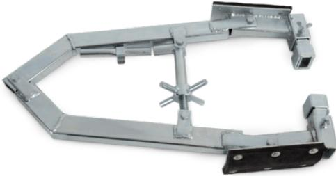
Die **Verbaugeräte** sind eine einfache und sichere Lösung, Rohrverschlüsse und Rohrprüfgeräte praxisgerecht gegen Herausschieben zu sichern. Im Vergleich zu einem herkömmlichen, aufwendigen und zeitintensiven Holzverbau können sie schnell und beliebig oft eingesetzt werden. Selbst bei glatten oder schlüpfrigen Rohrwänden wird ein zuverlässiger Verbau durch die Spezial-Gummibeläge erreicht.
