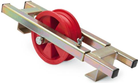
Das **Schachtoberkante Umlenkgerät** wird auf den Schacht aufgesetzt, um Verschleiß am Kanalreinigungsschlauch vorzubeugen (für Hochdruckschläuche und Kamerakabel). Darüberhinaus wird der Reinigungsvorgang für den Bediener erleichtert – besonders praktisch in Situationen, in denen sich die Schlauchtrommel nicht in der Nähe der Kanalöffnung platzieren lässt.
