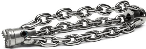
Die **Tiger Original PVC-Ketten** werden in PVC- und brüchigen Rohre eingesetzt, da sie mit ihren Glattketten die Rohrwandung schonen. Gegenüber den Standard PVC Ketten verfügen die Bohrketten über einen vorderen Bohrkopf mit langlebigen Hartmetallen, dieser dient dem effizienten und sicheren Durchtrennen von Wurzeln, Entkalken und Beheben von Verstopfungen.
