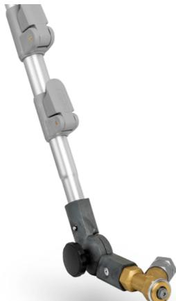
Die robuste **Teleskop-Schachtreinigungslanze** dient dem Reinigen von Schächten und anderen Flächen. Die Schachtlanze lässt sich von 1.750 - 6.000 mm (Kurze Version 1.300 - 3.500 mm) stufenlos ausziehen und bietet somit die Möglichkeit, tiefe Schachtbauwerke bequem von der Schachöffnung aus zu reinigen.
