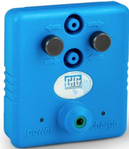
Diese Smart Charger Cap dient dem schnellen Aufladen der Gaswarngeräte Microtector Typ G450 / G460 sowie dem schnellen Justierung der Geräte. Dazu wird die Smart Cap aufgeschraubt und mit entsprechenden Prüfgasen versehen.
