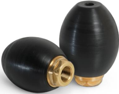
Die **Schub-Twisterdüse** hat keinen Vortrieb, die gesamte Wassermenge steht dem Rotationsvorstrahl zur Verfügung. Somit kann die Düse an jedem handelsüblichen Hochdruckreiniger verwendet werden und ist die perfekte Lösung bei Rohrverstopfungen im Hausanschlussbereich.
