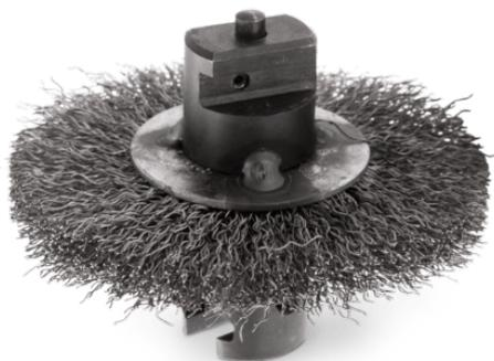
Die **Scheibenbürsten** dienen dem Reinigen von Stahl-, Guß-, Steinzeug- und Kunststoffrohren und der Sanierungsvorbereitung. Der Draht legt sich an die Rohrwandung an und bürstet sie frei. Dabei werden vor allem anhaftende Fettrückstände und Inkrustierungen, aber auch feine Wurzelgeflechte und Verschlammungen effektiv beseitigt. Das Bürstenwerkzeug schließt die professionelle Rohrreinigung optimal ab.
