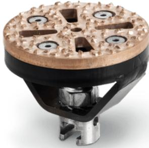
Die **Scheiben-Fräser** wurden speziell für härteste Inkrustierungen, Betonablagerungen und ähnliches entwickelt. In einem speziellen Verfahren werden Hartmetallteilchen auf die Oberfläche des Bohrers aufgetragen und anschließend gehärtet. Dadurch ist das Werkzeug bruch- und schlagfest und kann eine hohe Standfestigkeit gewährleisten.
