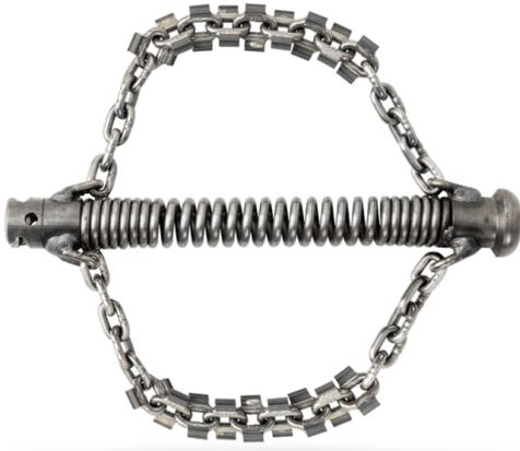
Die **Sägezahn-Kettenschleuder** mit ihren aufgelöteten Hartmetallsägezähnen wird speziell zur Beseitigung von Wurzeln und harten Inkrustierungen eingesetzt.
