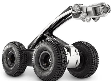
Der größte **Fahrwagen RX400 des Rovion-Systems von IPEK** wurde für größere Rohrdimensionen mit hohen Durchflussraten entwickelt. Er bietet ein komfortables Arbeiten in schwierigen Umgebungen – der Einsatzbereich liegt dabei von DN 400 bis DN 1.300 mit der optionalen Kameraerhöhung sogar bis DN 2.200.
