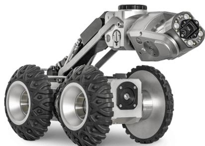
Der **RX130L** ist der mittlere Fahrwagen des Rovion-Systems von IPEK. Der Fahrwagen verfügt über einen integrierten motorischen Heber zur stufenlosen Einstellung der Kamerahöhe. Der Fahrwagen ist damit für einen Anwendungsbereich von DN150 bis DN600 geeignet. Mit optional erhältlichem Zubehör wie der Lafette wird der Einsatzbereich von DN150 auf bis zu DN1.000 erweitert.
