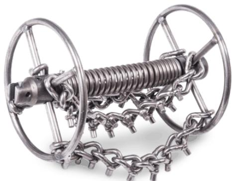
Die **Ring-Kettenschleudern** mit ihrer besonderen Bauart hat den Vorteil, dass sie sich beliebig oft zerlegen, verändern und wieder montieren lässt. Dazu benötigen Sie nur wenige Minuten und kein Spezialwerkzeug. So können Ketten auch ohne schweißen getauscht werden. Die Ringe schränken die Bogengängigkeit natürlich stark ein, weshalb sich Kettenschleudern mit Ring nur für lange, gerade Leitungen eignen.
