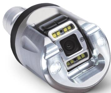
Die **Schwenkkopfkamera PTC50** kommt am ROVION Inspektionssystem von IPEK zum Einsatz. Der Einsatzbereich beginnt bei DN100. Die Kamera verfügt über eine Endlosrotation und einen großen Schwenkbereich. Sie zeichnet sich durch ihre hochwertige und robuste Bauweise und sehr guten optischen Eigenschaften aus.
