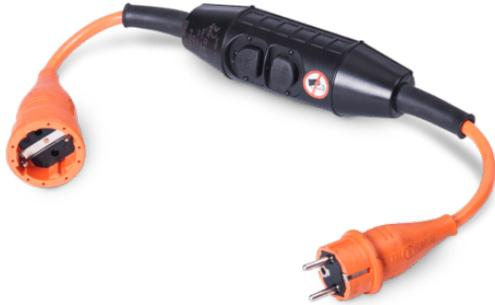
Der **Personenschutzschalter (FI-Adapter)** erkennt Fehlerströme und unterbricht den Strom so schnell, dass lebensgefährliche Unfälle verhindert werden (10 mA Auslösestrom), auch als Erweiterung für andere Maschinen mit 230 V verwendbar.
