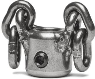
Die Picote **Reinigungsketten in kurzer Version** kommen ohne Hartmetallzähne. So sind sie weniger aggressiv und ideal zum Reinigen von empfindlicheren Rohren aus Kunststoff, Kupfer und Steinzeug.
