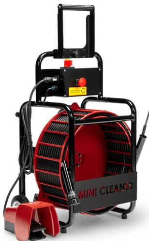
Die **Mini Cleaner Maschinen** wurden speziell zum Reinigen, Entkalken, Wurzelentfernen, Fräsen und Beschichten in kleinen Rohrdurchmessern ab DN32 - 75 mm entwickelt. Die hoch flexible Welle erlaubt Arbeiten in kleinen Rohrdurchmessern, sogar mit mehrfachen 90°-Bögen und Siphons bis DN50.
