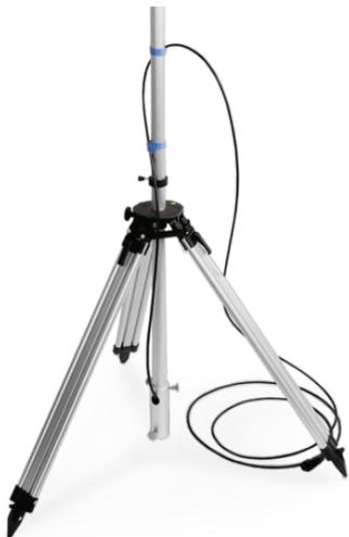
Das digitale **Pegelmessgerät AIR-PLUS** dient der Messung von Pegeländerung bei Dichtheitsprüfungen mit Wasser von Abscheiderbauwerken, Kleinkläranlagen, Schächten und Behältern.
