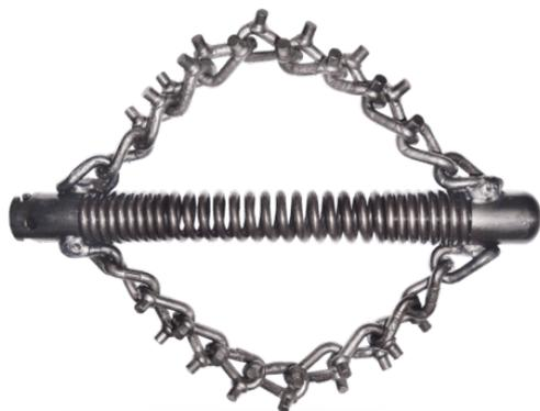
Die **Kettenschleudern mit Nockenkette** sind ideal für Steinzeug- und Betonrohre. Sie beseitigen leichte Wurzeln und Inkrustierungen (auch trockene Schollen). Sie bestehen aus gehärtetem Stahl, gegenüber Kettenschleudern in Sanitärausführung nutzen sich diese Profiwerkzeuge weniger ab, was mehr Reinigungskraft bedeutet. Für Guß- und Kunststoffrohre empfehlen wir den Einsatz der Glattketten.
