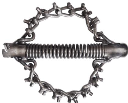
Die **kurze Version der Kettenschleuder mit Nockenkette** ermöglicht gegenüber der großen Version eine verbesserte Bogengängigkeit und ist ideal für Steinzeug- und Betonrohre. Sie beseitigen leichte Wurzeln und Inkrustierungen (auch trockene Schollen). Sie bestehen ebenfalls aus gehärtetem Stahl, dadurch nutzt sich das Profiwerkzeug weniger schnell ab.
