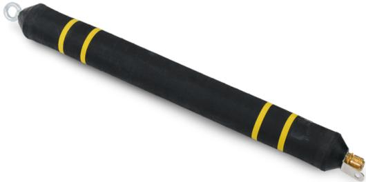
Die **Multi-Packer 70-150** bestehen aus sehr strapazierfähigem und dickwandigem Gummimaterial mit 2 zusätzlichen Cordeinlagen, dadurch sind dieser Packer sehr robust und besitzen ein sehr hervorragendes Dehnverhalten, so dass sie einen größeren Einsatzbereich gegenüber den Normalen Sanierungspacker aufweisen. Die Anpresslänge beträgt von 600 mm bis 4.000 mm.
