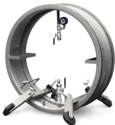
Die **mehrteiligen Rundprofil-Muffenprüfgeräte** ermöglichen eine unkomplizierte Teilung des Prüfgerätes in 3 bzw. 4 Teile. Dadurch ist das Einbringen auch durch eine Schachttöffnung möglich. Vor Ort lassen sich die Muffenprüfgeräte mit wenigen Handgriffen wieder zusammensetzen.
