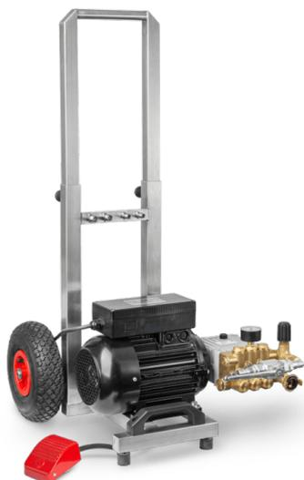
Das **mobile Hochdruckspülgerät Rohrboy** ist der kleine Helfer für große Probleme im Hausanschlußbereich. Mit seiner Leistung von 20 Liter pro Minute bis 75 bar, Schiebeschlauch und dem speziellen Twistereinsatz (Rotordüse) sind Rohrverstopfungen kein Problem mehr.
