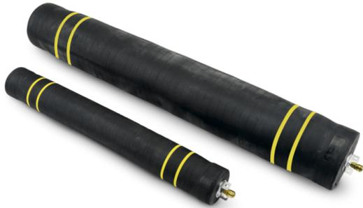
Unser **Langpacker** ohne Radwerk und ohne Durchgang werden in der Rohr-, und Kanalsanierung für Sanierungsarbeiten eingesetzt bei denen kein Abwasserfluss benötigt wird. Die flexible Bauweise erlaubt eine Sanierungslänge von 100 cm bis 400 cm, beim Rohrdurchmesser von 200 bis 800 mm.
