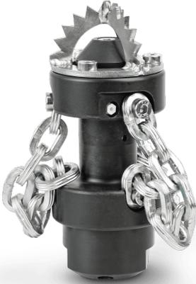
Die **Kettenschleuder** ist ein Rotationswerkzeug, das vorwiegend zur Beseitigung von Wurzeln oder festen Ablagerungen, wie Kalk und Zementschlamm, eingesetzt wird. Der mit drei Antriebsdüsen versehene Rotor wird so in Rotation versetzt, dass die auf den Rohrdurchmesser angepasste Kette zur Zentrierung der Kettenschleuder im Rohr führt. Durch die genau definierte Schleifwirkung der Kette sowie den 90°-Aufprallwinkel der Antriebsstrahlen ergibt sich die sehr gute Abbauleistung der Spezialdüse.
