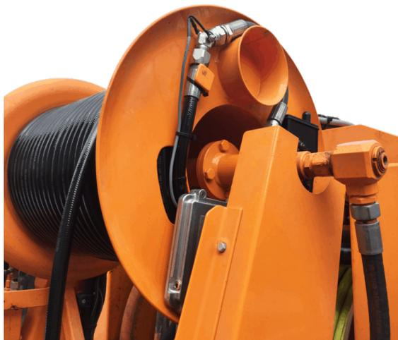
Die **Truckversion** der Jetcam 40 wird direkt an ihrem Hochdruckspülfahrzeug montiert - Plug´n´Play: Schleifringlos, direkt an der bestehenden Haspel montierbar, Schlauch, Steuerbox und Akku drauf und los gehts! Reinigen, Inspizieren, Abbiegen und Dokumentieren in einem Arbeitsgang.
