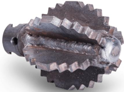
Der **Igelfräser** ist speziell für Fallleitungen entwickelt worden. Hier entfernt er mühelos schwere Inkrustierungen mit seinen 6 lasergeschnittenen starken Fräsblättern, welche in beide Richtungen Zahnungen aufweisen. Das hohe Eigengewicht ist besonders gegen schwere Inkrustierungen in Fallleitungen geeignet.
