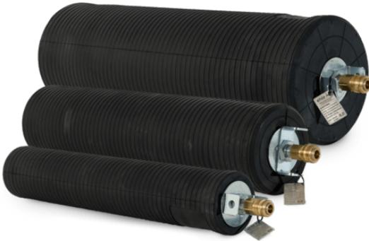
Die **Hochdruck-Rohrdichtkissen** kommen immer dann zum Einsatz, wo keine Standard-Dichtkissen wegen eines hohen Gegendrucks in der Rohrleitung eingesetzt werden können. Der höhere Betriebsdruck von (6,0 bar) ermöglicht eine besondere Kevlar-Gewebeeinlage, sie hält einem Gegendruck bis zu 30 m Wassersäule (3,0 bar) stand.
