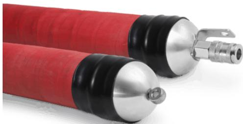
Die **Hausanschluss-Packer DN 80 - 125 mm** wurden speziell für den Einsatz von Kurz- und Lang-linern in der Kanalsanierung entwickelt. Besonderes Augenmerk wurde dabei auf leichte Bauweise und vielseitigen Einsatzbereich gelegt. Der rote Spezial-Blähschlauch mit einer weichen Kautschukmischung ermöglicht besonders glatte Anpressflächen und optimale Übergänge vom Liner.
