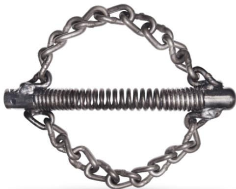
Die **Kettenschleudern mit Glattkette** bestehen aus gehärtetem Stahl, gegenüber Kettenschleudern in Sanitärausführung nutzen sich diese Profiwerkzeuge weniger ab, was mehr Reinigungskraft bedeutet. Die glatten Ketten sind für Guß- und Kunststoffrohre ideal, die Nockenketten sind für Steinzeug und Betonrohre designt.
