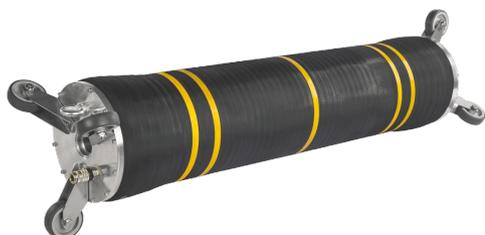
Die **flexiblen Sanierungspacker DN 200 – 300 mm mit Durchgang** ermöglichen das Sanieren von Rohrabschnitten auch bei stark wasserführenden Leitungen. Ein Umleiten oder Umpumpen ist nicht notwendig. Durch ihre flexible Konstruktion können die Packer leicht durch eine Schachtoffnung geführt und in der beschädigten Leitung installiert werden.
