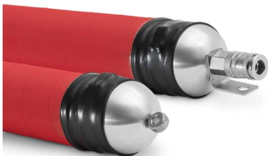
Die **Flex-Packer DN 100 - 150 mm** wurden speziell für den Einsatz von Kurz- und Langlinern in der Kanalsanierung entwickelt. Besonderes Augenmerk wurde dabei auf leichte Bauweise und vielseitigen Einsatzbereich gelegt. Der rote Spezial-Blähschlauch mit einer weichen Kautschukmischung ermöglicht dabei besonders glatte Anpressflächen und optimale Übergänge vom Liner zu dem sanierenden Rohr.
