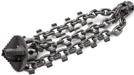
Die **Express Bohr-Ketten mit Standard-Hartmetallbesatz** bieten eine wertvolle Zeitersparnis bei der Anschluss-Wiederherstellung nach einer Sanierung. Sie ermöglichen das Öffnen von Seitenanschlüssen und Abschleifen überschüssigen Liners ohne Werkzeugwechsel. Für erfahrene Sanierungsteams ist dieses neue Tool eine echte Bereicherung! Darüberhinau eignen sie sich auch zum Lösen von Verstopfungen und Entfernen von Wurzeln.
