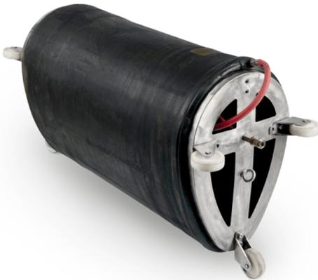
Die **Ei-Profil Packer** werden für die partielle Sanierung von Ei-Profil Rohren verwendet. Mit dem Durchgang wird ein maximaler Abwasserfluss gewährleistet. Die kurze Bauweise von ca. 1 m erleichtert das Handling mit dem bestückten Packer.
