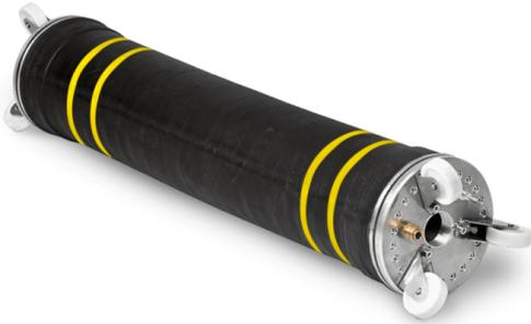
Die **Durchgang Flex-Packer 450-1200** bestehen aus einem Einschicht-Gummikörper und zwei Metallköpfen mit Fahrwerk (3x 120°), die für stabile Bewegung des Packers in der Rohrleitung sorgen.
