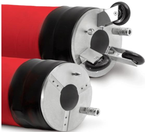
Die **Flex-Packer DN 250 - 400 mm mit Durchgang** ermöglichen das Sanieren von Rohrabschnitten auch bei stark wasserführenden Leitungen. Ein Umleiten oder Umpumpen ist nicht notwendig. Der rote Spezial-Blähschlauch mit einer weichen Kautschukmischung ermöglicht dabei besonders glatte Anpressflächen und optimale Übergänge vom Liner.
