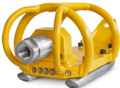
Die **Bulldozer Räumdüsen** sind sehr schwere Kanalreinigungsdüsen deren gesamte Wasserleistung sich auf die zu reinigende Kanalsohle konzentriert. Sie eignet sich besonders für schwere sandige, schlammige oder steinige Ablagerungen. Die Düsen verfügen über auswechselbare Kufen aus gehärtetem Stahl.
