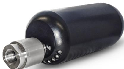
Durch ihre spezielle Konstruktion (Pendelgewicht) und einem Anschlussgewinde, das nicht mittig positioniert ist, pendelt sich die Düse immer aus und richtet sie sich so optimal zur Kanalsohle aus. Durch ihre Formgebung sind große Versätze beim Zurückziehen kein Problem.
