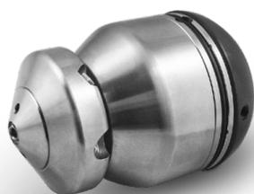
Die **Blue 50 Rotationsdüse** - ist eine Düse, die fast alle Probleme löst. Zum Beseitigen von Fettablagerungen, Inkrustierungen, schwere mineralische Ablagerungen, Verstopfungen und Verwurzelungen. Sie reinigt größere Durchmesser schneller, mit weniger Wasser gegenüber herkömmlichen Düsen.
