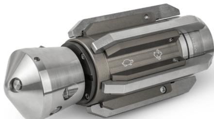
Die **Blue 100 Transformer** - ein Werkzeug für vielfältige Anwendungen. Die modular aufgebaute Rotationsdüse ermöglicht Arbeiten im Durchmesser ab 150 mm bis 400 mm (Als Großprofilreinigungsdüse sogar bis max. 2.400 mm je nach Aufbau optionales Zubehör erforderlich).
