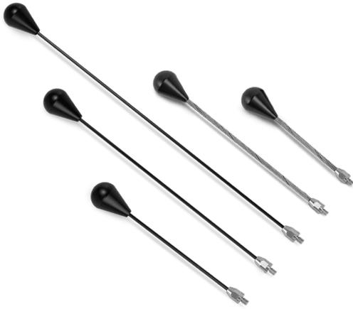
Mit den **Abbiegestäbchen** werden Inspektionen über Rohrabzweige im Schiebebetrieb möglich. Das Abbiegestäbchen wird in den Abzweig abgeschwenkt und durch die Führung biegt die Kamera in die Leitung ein.
