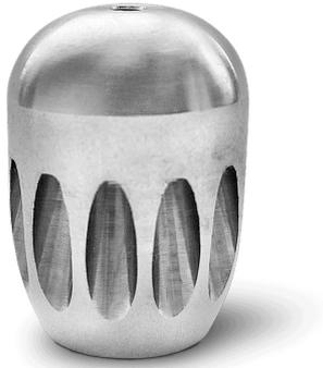
Die **360° Reinigungsdüse** mit 12 Düseneinsätzen bietet hervorragende Reinigungsleistung auf die komplette Rohrwandung in 360°. Der geringe Strahlwinkeln von 15° bietet ausserdem besonders gute Abschwemmlösungen bei hohen Zugeigenschaften. Beim Zurückziehen der Düse werden Verschmutzungen wie Schotter, Sand, Kies etc. gelöst und das Rohr wird komplett gereinigt. Die Zugdüse ist Standardmäßig mit Vorstrahl ausgerüstet.
