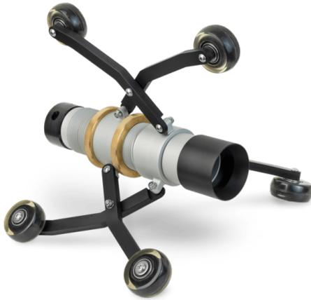
Der stufenlos **verstellbare Rollenschlitten** mit 3-Punkt fahrwerk dient dem reibungslosen Führen der Schiebekameraköpfe für Dreh- / Schwenkkopfkameras und Axialkameras auf langen Strecken und ermöglicht die Zentrierung in Rohrmitte ab DN 200 - 400 mm.
